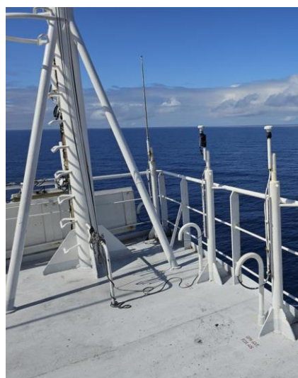
Рис. 1.4. Антена автоматичного розпізнавання (Automatic Identityfication System): а – контейнеровоза MAERSK KALMAR; б – контейнеровоза SPYROS V.
