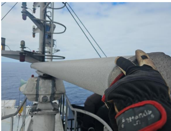
Рис. 1.3. Антена радару (Sperry Marine): а – контейнеровоза MAERSK KALMAR; б, в – контейнеровоза SPYROS V.
