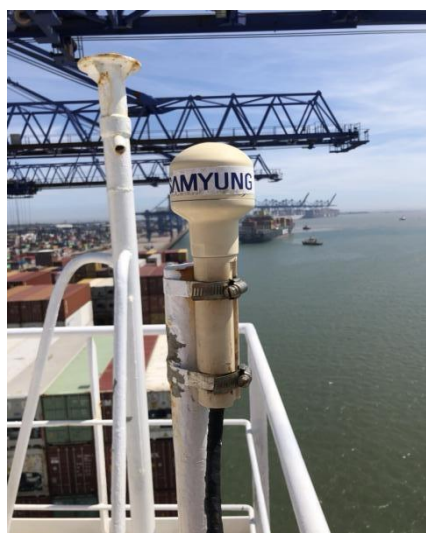
Рис. 1.4. Антена автоматичного розпізнавання (Automatic Identityfication System): а – контейнеровоза MAERSK KALMAR; б – контейнеровоза SPYROS V.
